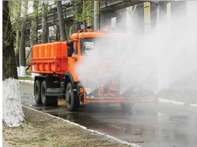
фронтальная высоконапорная рейка, которая в последнее время все чаще находит применение. Но на современных машинах в основном стоят оба типа этих моечных агрегатов для возможности решения более широкого спектра задач: как для эффективной высоконапорной мойки покрытия, так и для проведения полива.
